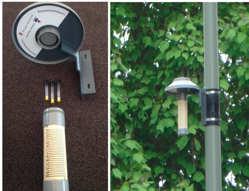
Diffusiebuisjes en houder zoals gebruikt voor het onderzoek
